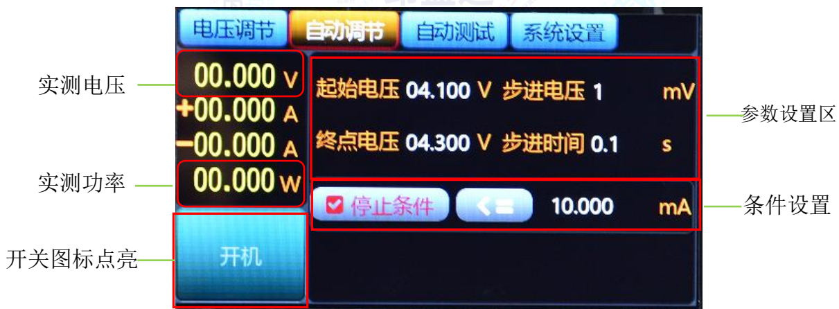
图5.5.1 电池充电饱和测试
